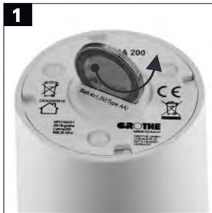
Öffnen Sie das Batteriefach, indem Sie den Deckel mit einer Münze gegen den Uhrzeigersinn aufdrehen.
