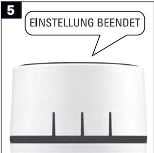
7 Sekunden nach der letzten Tastenbetätigung hören Sie „Einstellung beendet“. Der LED-Ring leuchtet ab sofort in der eingestellten Farbe, wenn der Funkklingeltaster betätigt wird.
