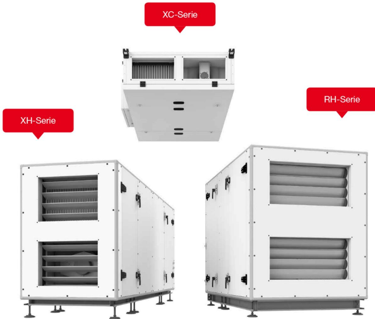
Wenn Sie Großes planen, finden Sie jetzt bei Helios genau die richtige Lösung für die energieeffiziente Lüftung mit Wärmerückgewinnung. Die neue Helios AIR1 Produktfamilie bietet Ihnen mit **3 Geräteserien** verschiedene technische Varianten: für die Decken- oder Stand-Montage, mit hocheffizienten Kreuz-gegenstrom- oder Rotationswärmetauschern sowie für den Einsatz innen oder außen.
