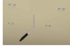
3. Halten Sie das Heizelement so, dass das Steckerteil an der linken, oberen Seite ist, und hängen Sie das Heizelement zunächst mit den hinteren Montagebügeln in die Deckenhalter.
