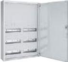
bestehend aus: AP-Leergehäuse mit Volltür, Verteilerfeld für Reiheneinbaugeräte, mit geschlossener Abdeckung und isolierten Hutschienen für Reihenklemmen | 300 x 800 x 160             | 60  | 1              | 1   | <b>MK15RK</b> | 395,50 €    |
